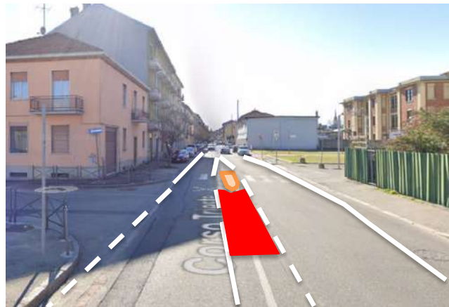
Attraversamento pedonale protetto salvaped.
